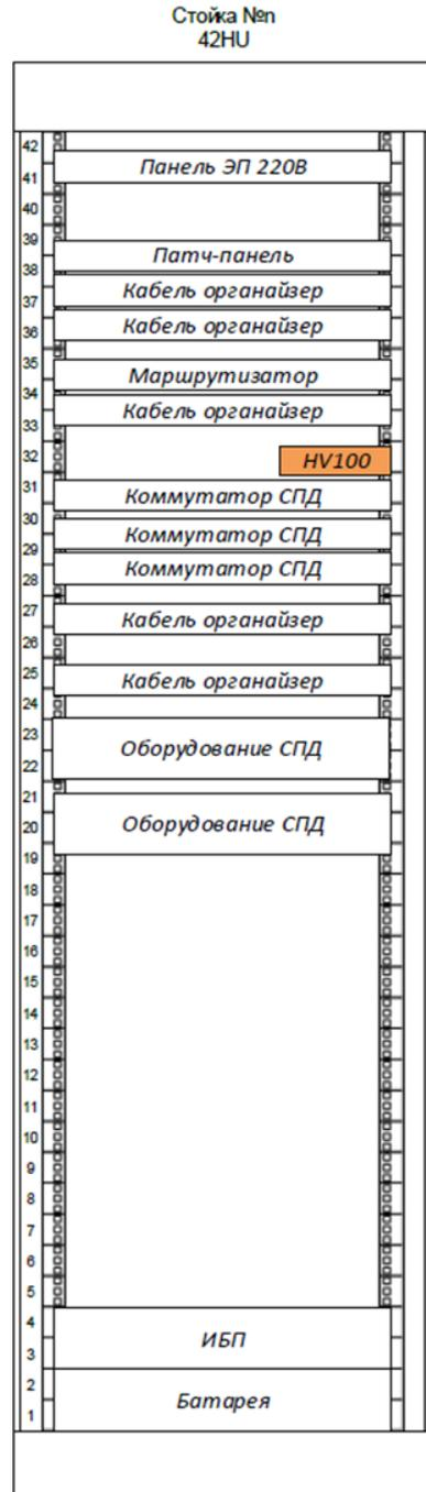
**Вариант размещения криптомаршрутизатора HV100 В стойке серверного (коммутационного) зала подключаемого по временной схеме аэропорта (объекта).**
